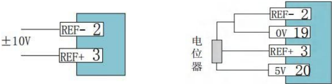
图3.2.2 外部电源模拟量输入接线
